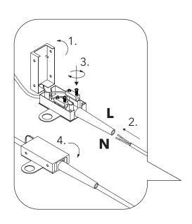
Weißen Kabelschutz vorsichtig mit Schlitzschraubenzieher öffnen.
