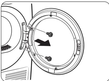
4. Entfernen Sie die Scharnierschrauben und nehmen Sie die Tür ab.
