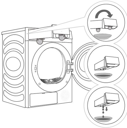
**1** Nehmen Sie den Kondensattank aus dem Trockner.
