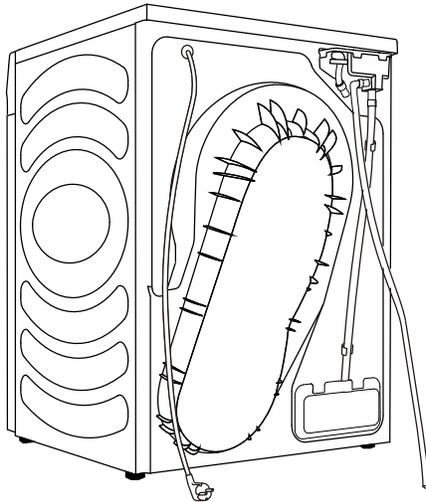
**1** Nehmen Sie den Ablaufschlauch vom Gerät ab und hängen Sie ihn an der Rückseite auf.
