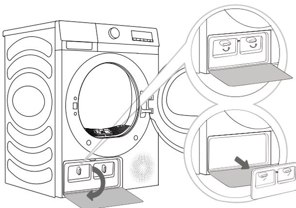
**1** Drücken Sie auf den Verschluss der Verkleidung der Wärmetauschertür unten links, um die Türverkleidung zu öffnen.
