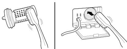
**6** Nach dem Reinigen des Ablaufpumpenfilters setzen Sie den Filter vorsichtig wieder ein und schrauben Sie die Abflussskappe im Uhrzeigersinn vorsichtig wieder ein, um ein Überdrehen des Gewindes und Leckagen zu vermeiden.
