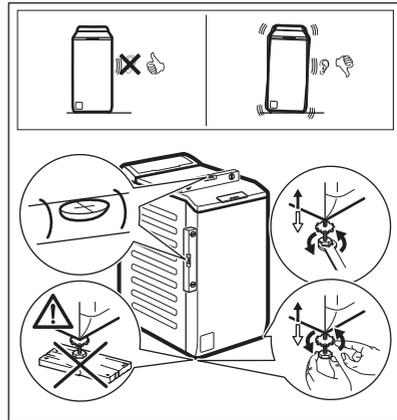
Richten Sie das Gerät korrekt aus, um Vibrationen, Geräusche und ein Wandern des Geräts während des Betriebs zu verhindern.
