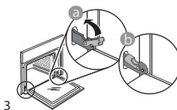
Versuchen, die Tür zu schließen und sicherstellen, dass sie auf das Bedienfeld ausgerichtet ist. Ist dies nicht der Fall, die oben aufgeführten Schritte wiederholen: Die Tür könnte beschädigt werden, wenn dies nicht richtig funktioniert.
