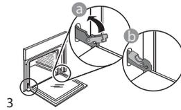
Versuchen, die Tür zu schließen und sicherstellen, dass sie auf das Bedienfeld ausgerichtet ist. Ist dies nicht der Fall, die oben aufgeführten Schritte wiederholen: Die Tür könnte beschädigt werden, wenn dies nicht richtig funktioniert.
