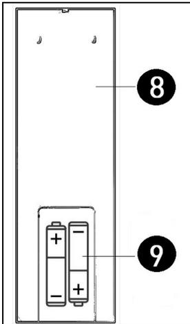
1. Nehmen Sie die Batteriefachabdeckung von der Fernbedienung ab. Üben Sie dazu im Bereich der Pfeilmarkierung einen sanften Druck auf die Batteriefachabdeckung aus und schieben Sie sie in Pfeilrichtung.
